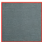
GH 100 U jyrsimellä saavutettu pinnanlaatu
