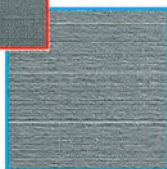
GH 100 U jyrsimellä saavutettu pinnanlaatu
